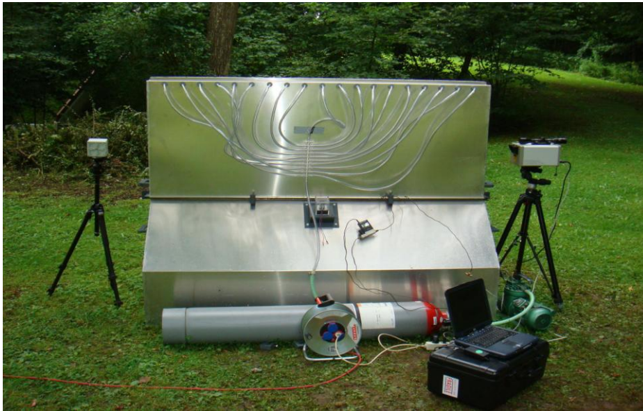
Abb. 7.17: Die Büsnau Box mit einem Gas-Rezirkulationssystem („Umluft“).
