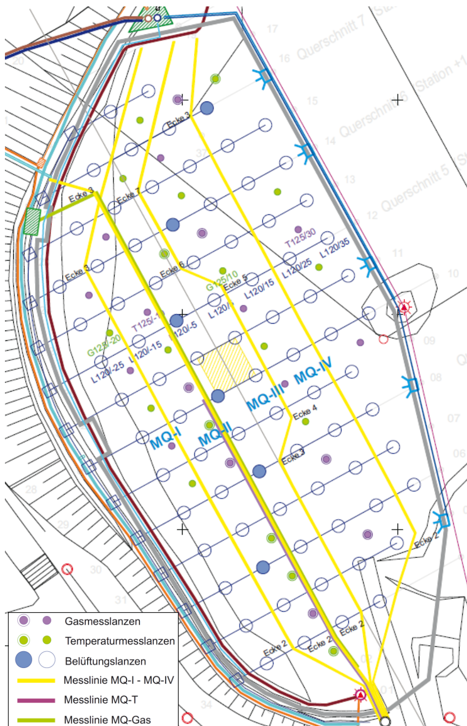
Abb. 6.6: Anordnung von Belüftungslanzen, Temperaturmesslanzen und Gasmesslanzen.
