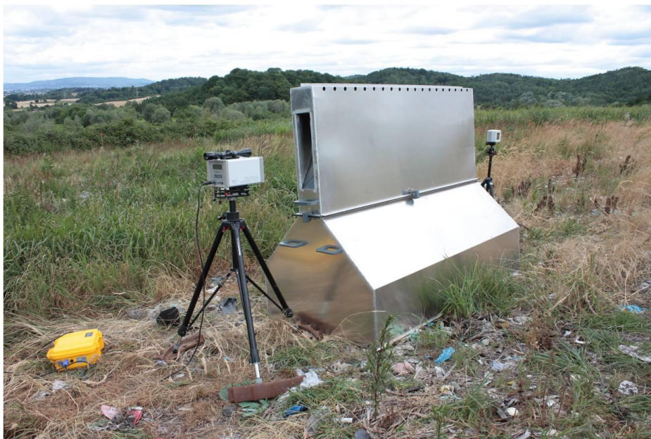
Abb. 7.21: Būsnau-Box Messung vom 08.07.2008, offen und ohne Umluft.
