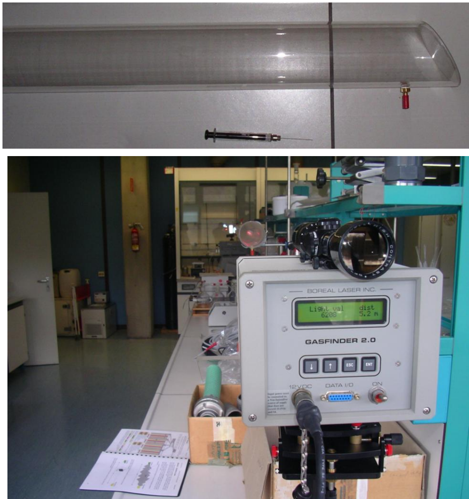
Abb. 7.4: Externe Kalibrierung des GasFinders im Labor.
