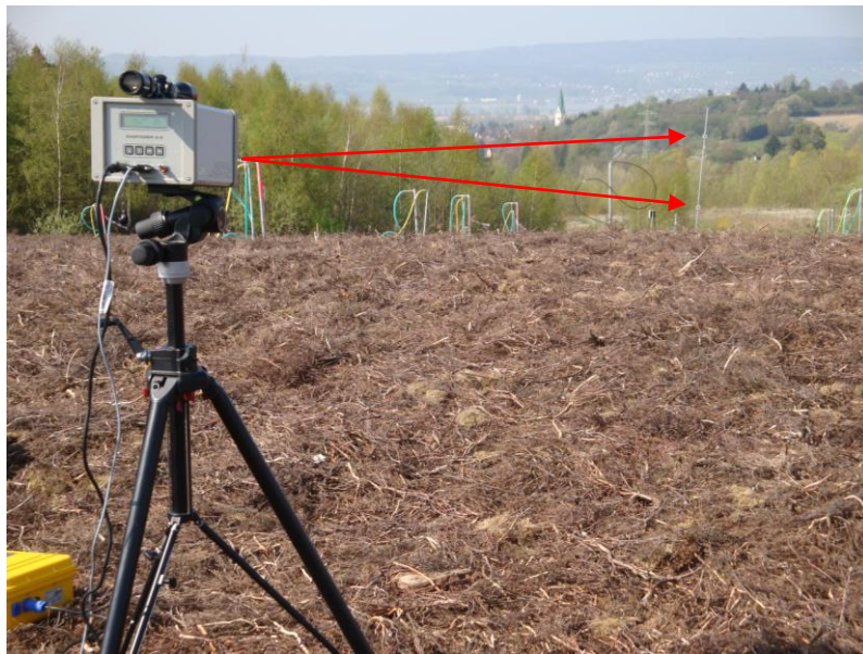
Abb. 7.6: Messaufbau von GasFinder und Retro-Reflektoren.
