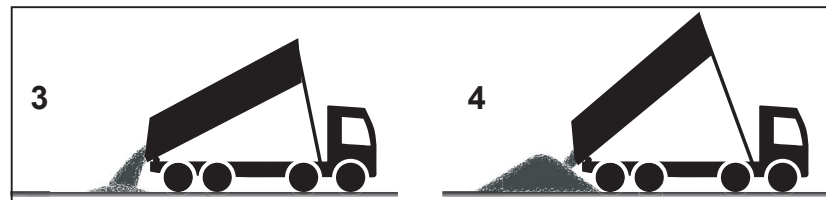
Abb. 1: Skizze des Abwurfvorgangs. Der Vorgang beginnt mit den Stufen 1 und 2 (Abwurf des Teilvolumens 1, hier nicht dargestellt) und großer Fallhöhe. Während Stufe 3 werden die Teilvolumina 2 bis 5 mit abnehmender Fallhöhe abgeworfen. Kurz nach Stufe 4 und Abwurf von Teilvolumen 6 rutscht kein Material mehr von der Ladefläche ab. Der Lkw fährt dann vor, um das Abrutschen des restlichen Materials zu ermöglichen.
