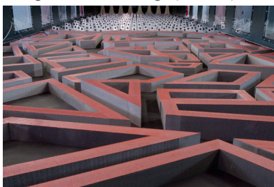
Abb. 1: Modell des Michelstadtfalls im Environmental Wind Tunnel Laboratory - EWTL der Universität Hamburg. Bildquelle: EWTL
