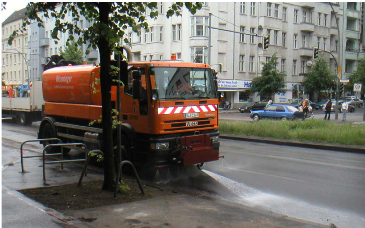
Abb. 2.2: Spülfahrzeug der Berliner Stadtreinigung bei der Straßenspülung
